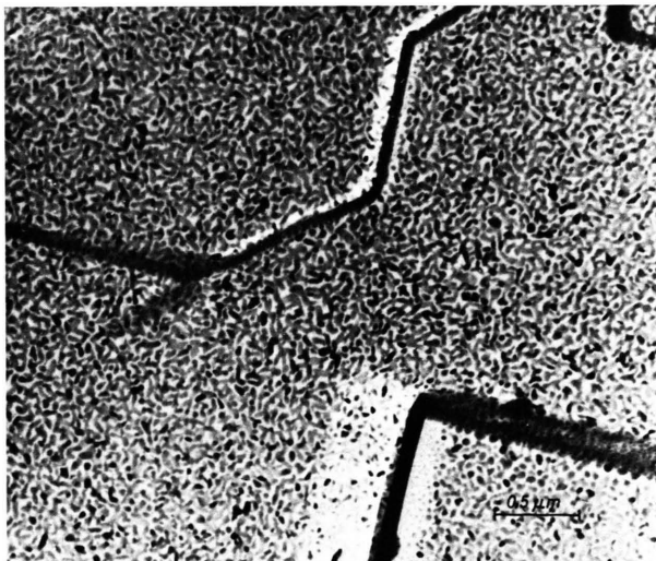
Abb. 8. Te auf C-Folie. C-Folie von RbJ-(100) abgenommen. Elektronenbild und Beugungsbild 60 kV. Selbst durch die elektronenmikroskopisch sehr deutlich abgebildeten Kanten findet keine Beeinflussung der Vorzugsorientierung der Te-Schicht statt.
